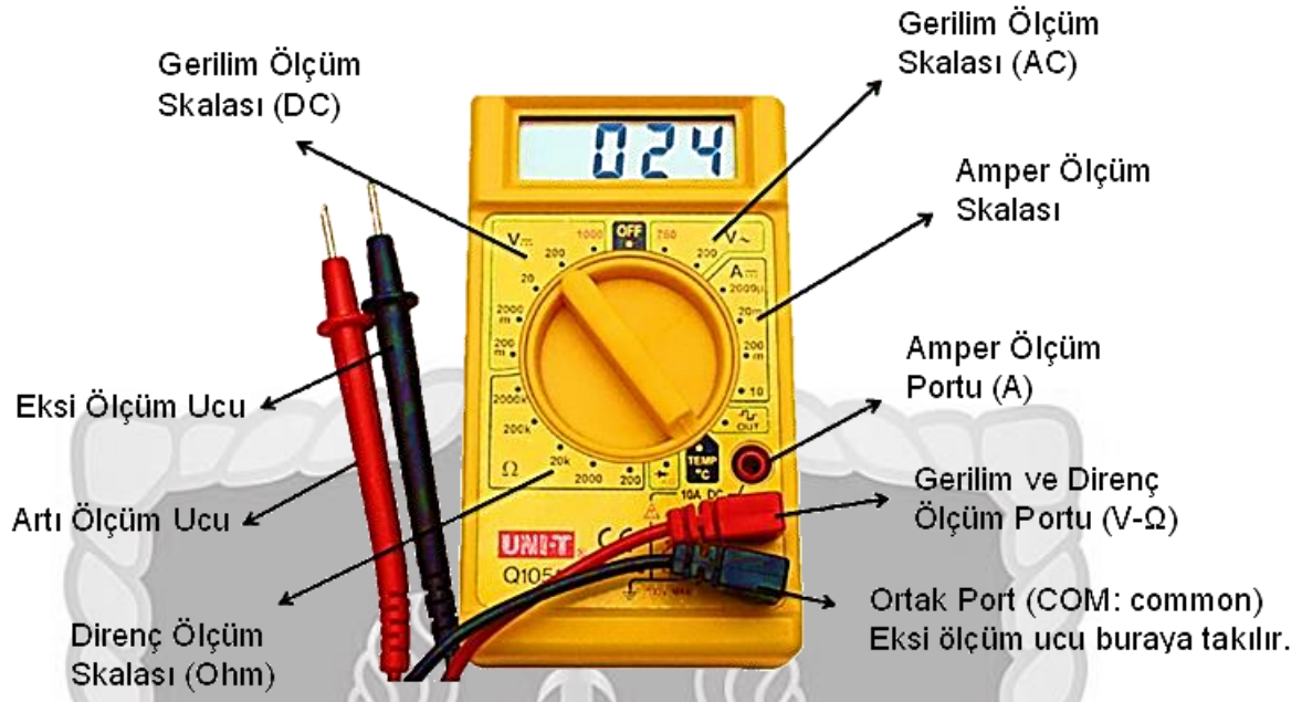
Şekil 1. Multimetre ve fonksiyon tuşları.
