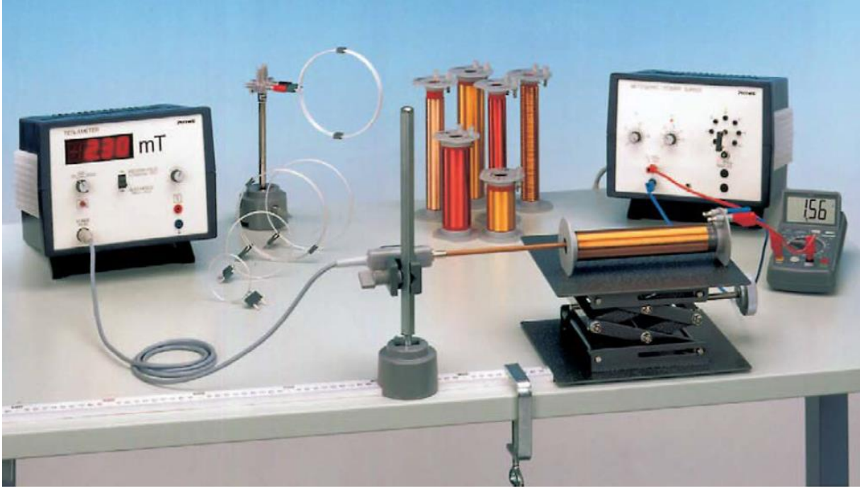
Şekil 4.2: İletken telden geçen akımın oluşturduğu manyetik alanın ölçülmesi.
